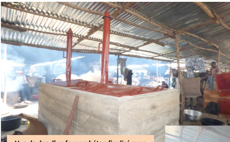
Vue de dos d'un four en béton finalisé avec ses accessoires
