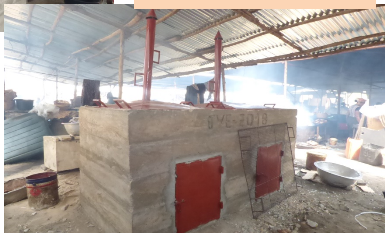
Vue de face d'un four en béton finalisé avec ses accessoires
