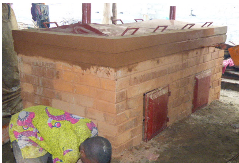
Four en briques autobloquantes prêt à l'utilisation avec ses accessoires
