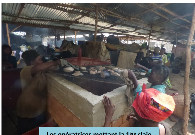
Les opératrices mettant la 1 ère claie de fumage à l'intérieur du four
